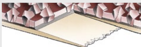
Überlappende Verbindung ohne Kornabschliff
