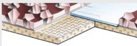
Gestossene Verbindung mit korntseitiger Spezialfolie
